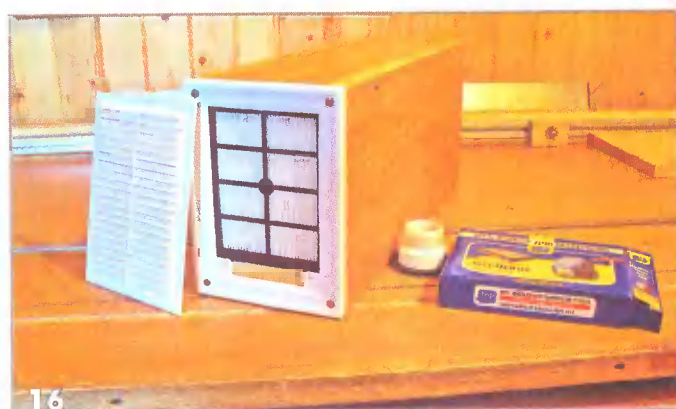
Деревянный короб, оборудованный высокоэффективным HEPA-фильтром
