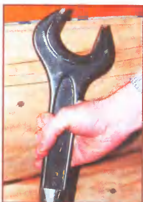
Пять опор, несущих перекрытие и размещённых внутри сруба, можно регулировать по высоте с помощью винтовых подпятников. Используемый для этого гаечный ключ имеет внушительные размеры
