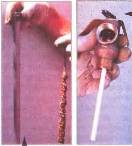
Анодный штырь защищает бак от коррозии. Электрод анодной защиты из магния или алюминия установлен через резьбовую втулку в крышке бака
