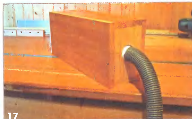
Деревянный короб, оборудованный высокоэффективным HEPA-фильтром
